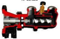
La Serie RF se basa en la misma tecnología que la serie R. Se diferencia en la utilización de un soporte cojinetes con árbol hueco de entrada. La serie RF puede conectarse directamente al accionamiento con una brida. La solución ideal para el suministro de la bomba sin motorización manteniendo la compacidad y la simplicidad de instalación. Los cojinetes garantizan la máxima fiabilidad sean cuales sean las condiciones de funcionamiento.
