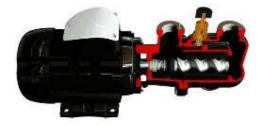
La Serie R es el producto más compacto disponible gracias a la construcción integrada entre la bomba y el motor eléctrico y una parte hidráulica sumamente corta. Utiliza una articulación de doble espárrago fiable y de mantenimiento sencillo. Sin soporte entre el cuerpo de la bomba y el accionamiento a favor de la compacidad y la simplicidad de mantenimiento.
