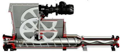
Versión dotada de tolva rectangular y cóclea ancha de alimentación de la parte hidráulica. En la tolva se ha instalado el Módulo "B" que incluye un dispositivo de rueda especial que alimenta la cóclea, evita la formación de puentes y da más fluidez a sustancias plásticas o pseudoplásticas. Apropiada para bombear sustancias no fluidas hasta el 40% de sustancia seca que tienden a formar puentes o en bloques.
